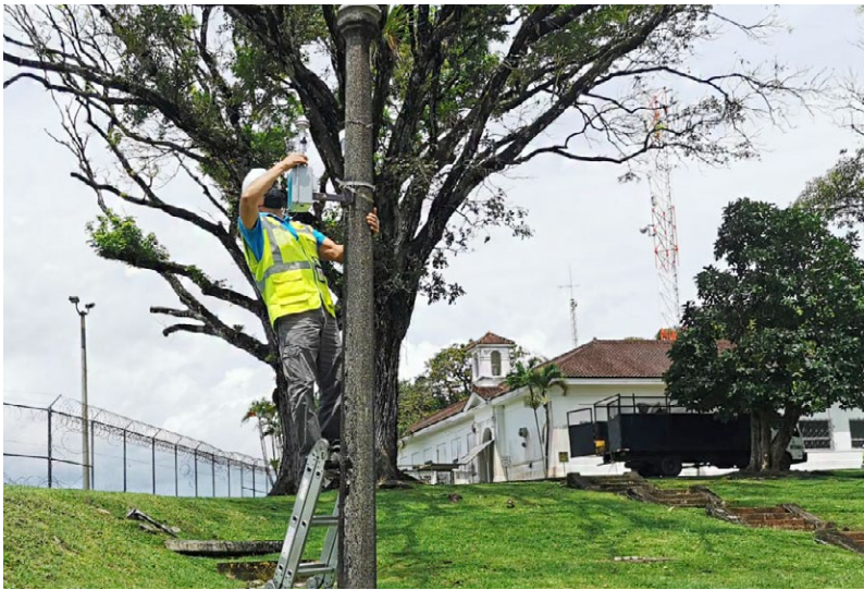
Técnico instala los filtros que retienen las partículas de aire.
